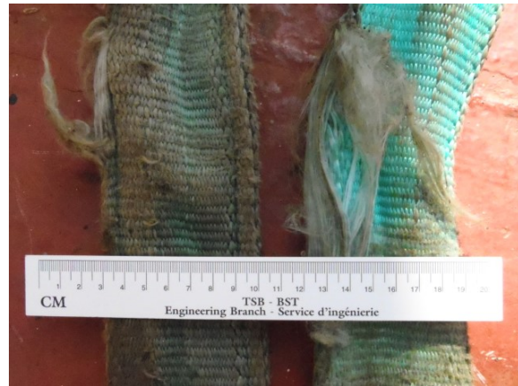
Photo 4. Ampleur de l'usure des élingues en nylon
