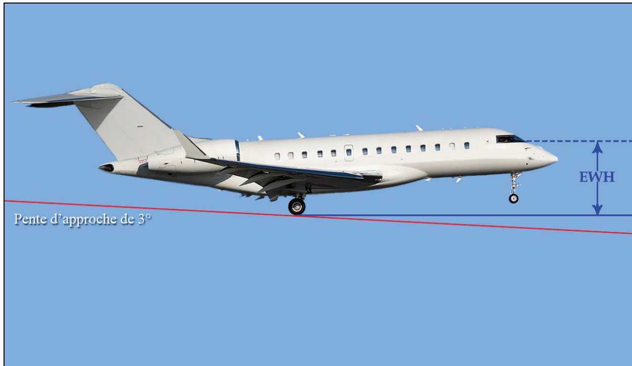
Photo 5. Hauteur entre les yeux du pilote et les roues de l'avion (EWH)
