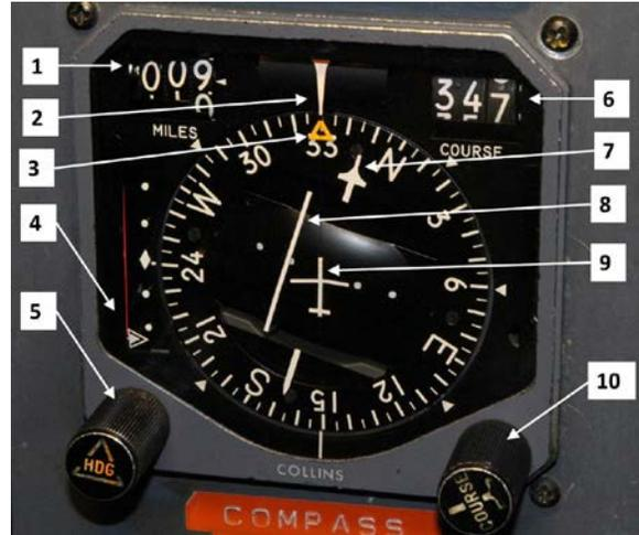
Figure 22. Exemple d'indicateur de situation horizontale (HSI)
