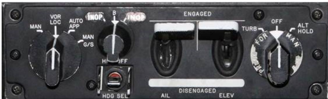
Photo 7. Panneau de commande de mode du pilote automatique
