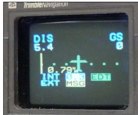
Photo 2. Écran du panneau de commande et d'affichage (CDU) du TNL-8100, indiquant un écart à droite
