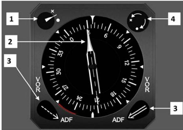
Figure 21. Exemple d'indicateur radiomagnétique (RMI)
