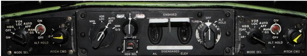
Photo 1. Panneau de commande de mode du pilote automatique et du directeur de vol
