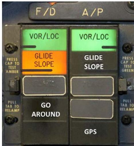
Figure 24. Exemple d'indicateur de progression d'approche (APD)
