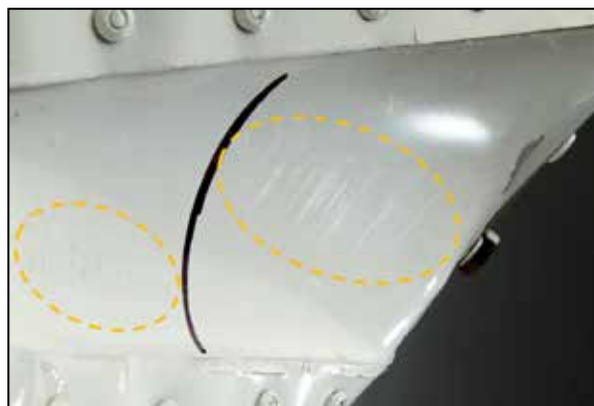
Photo 4. Éraflures sur la nervure de l'aileron
