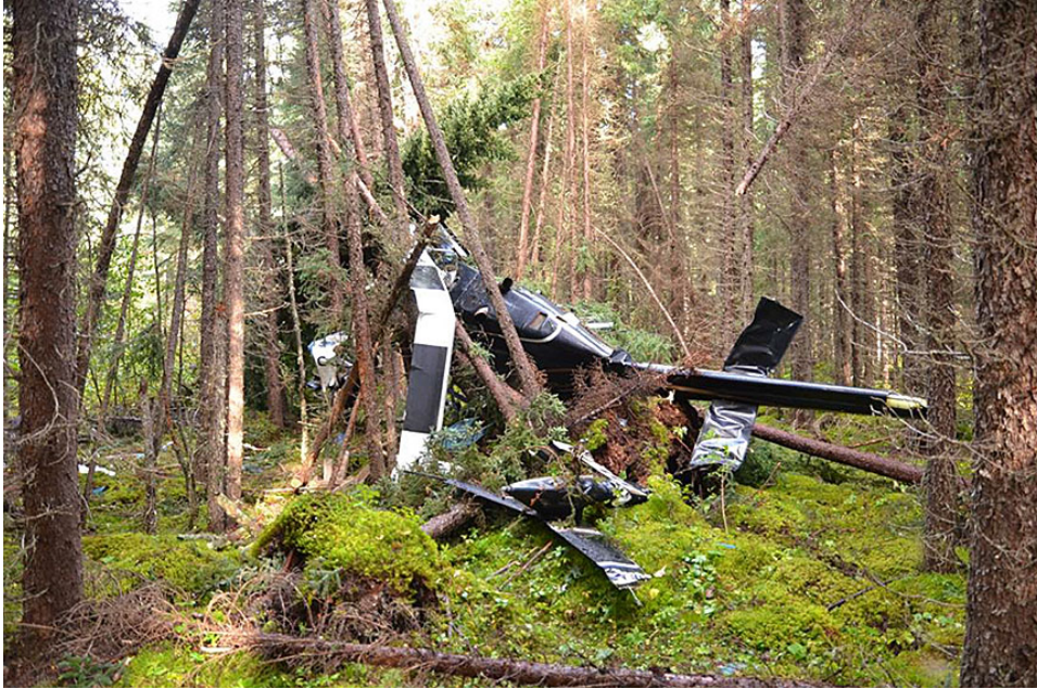
Figure 3. Vue du C-GHHU depuis l'arrière gauche (on aperçoit le plan fixe vertical sectionné à gauche de la poutre de queue)
