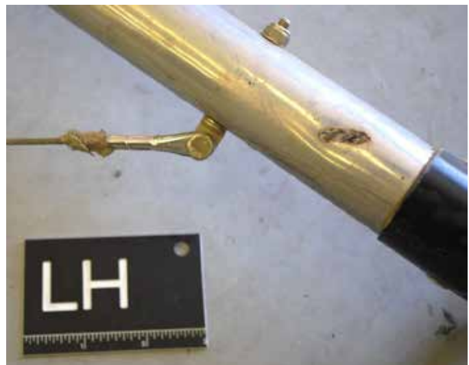
Figure 3. Gros plan des marques d'impact avec un câble sur la traverse tubulaire inférieure gauche
