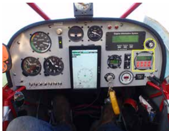
Figure 4. Tableau de bord de l'aéronef à l'étude montrant le programmeur Simple Digital System (carré jaune) et le bouton de commande de mélange air/carburant (cercle jaune) à droite sur le tableau de bord (Source : ancien propriétaire de l'aéronef)
