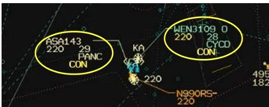
Figure 10. Gros plan de l'affichage de situation du Système canadien automatisé de la circulation aérienne montrant les étiquettes de données des 2 avions dans l'événement à l'étude après la modification de l'alerte TFC220 en alerte CON (Source : NAV CANADA, avec annotations du BST)
