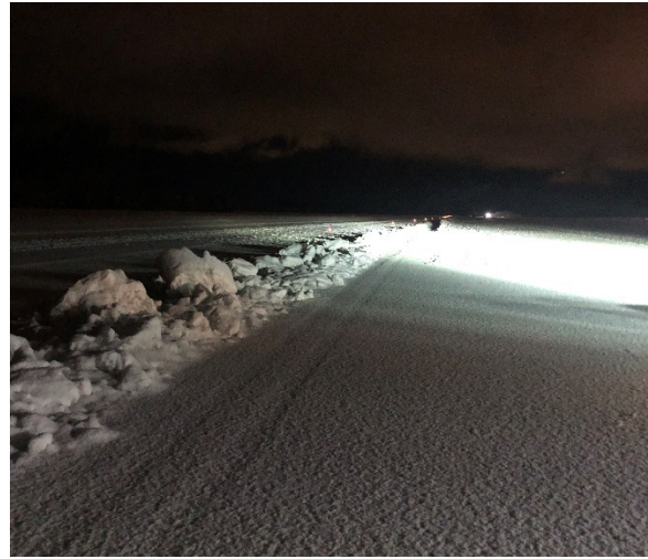
Figure 2. Andain et traces du train d'atterrissage principal gauche de l'aéronef à l'étude le long de la piste 33. Image prise environ 5 heures après l'événement (Source : Aéroport de Terrace)
