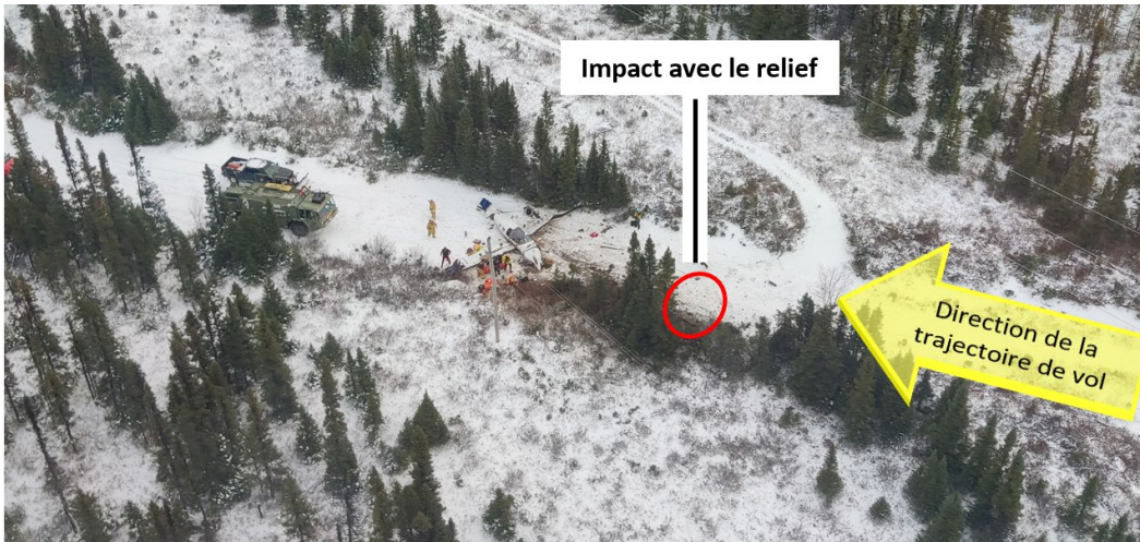
Figure 3. Vue aérienne du lieu de l'accident montrant la direction de la trajectoire de vol et l'endroit où l'aéronef a percuté le relief et s'est immobilisé (Source : Ministère de la Défense nationale, avec annotations du BST)
