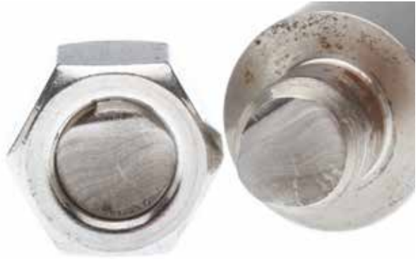
Figure 3. Goujon défaillant qui montre les deux moitiés de la surface rompue
