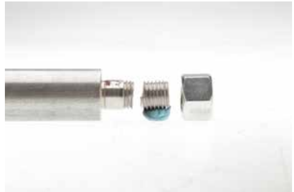
Figure 4. Vue latérale de la partie filetée du goujon qui est demeurée dans l'écrou
