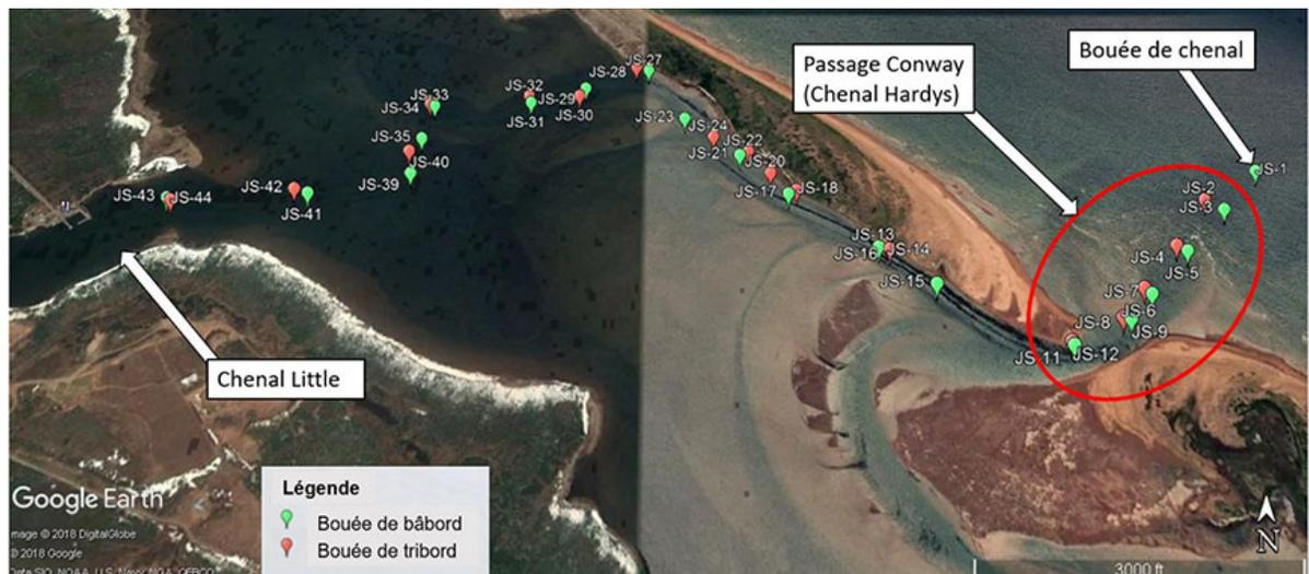
Une fois le *Roping the Wind* engagé dans le chenal Hardys, il est brièvement entré en contact avec une barre de sable au fond du chenal, et le régime moteur a ralenti. Le régime moteur a rapidement été rétabli, et le bateau a poursuivi son voyage jusqu'à ce qu'il s'échoue sur une autre barre de sable, près des dernières bouées de bâbord et de tribord du chenal, à environ 1,25 mille marin au nord-est de Rocky Point (Île-du-Prince-Édouard).
