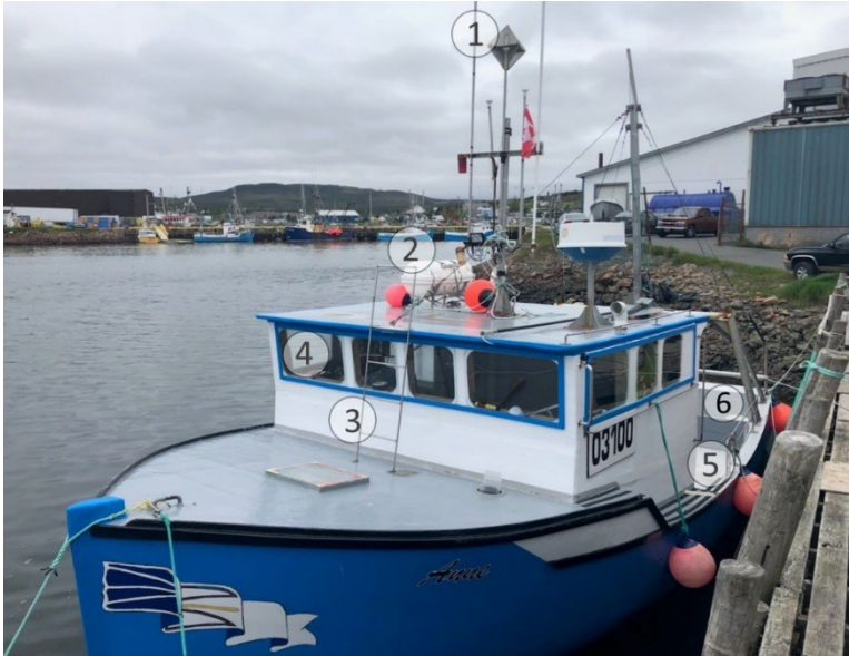
Figure 1. Photo du Sarah Anne avant l'événement, montrant le réflecteur radar (1), le radeau de sauvetage (2), l'échelle d'accès au radeau de sauvetage (3), le poste de pilotage de la timonerie (4), la section avant du pont de travail principal (5) et la zone d'entreposage arrière (6) (Source : Tiers, avec permission)
