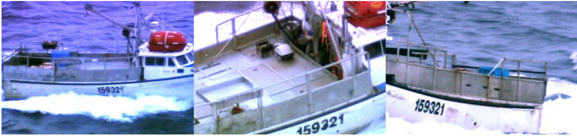
Figure 2. Trois photos montrant l'assise des pavois du pont amovible sur le dessus des pavois du pont principal (photo à gauche), l'espace entre le pont amovible et la timonerie (photo au centre) et la vue arrière du pont amovible (photo à droite) (Source : vidéo de Pêches et Océans Canada)
