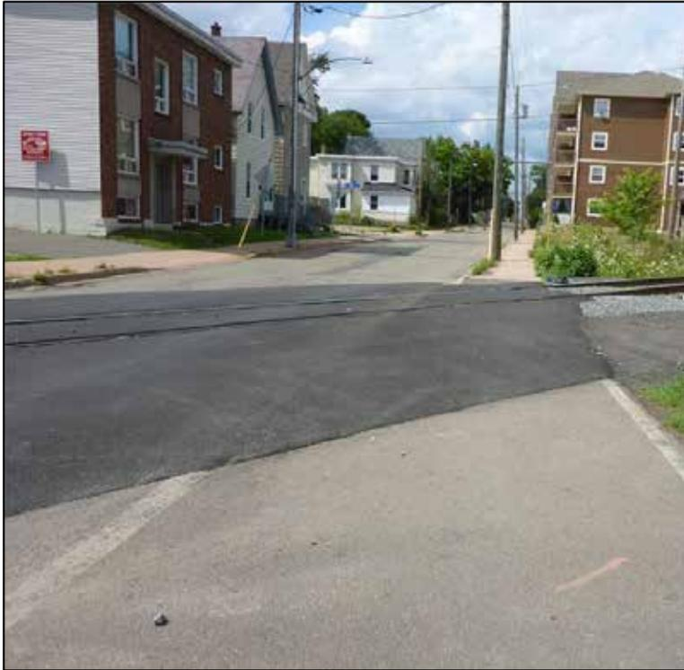
Figure 16. Approche du passage à niveau de la rue Robinson telle qu'elle devait se présenter la nuit de l'accident. Les lignes réfléchissantes avaient été repeintes sur le nouvel asphalte après l'accident, mais avaient été couvertes pour les besoins de la simulation.
