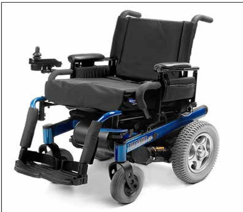
Dans l'événement à l'étude, le fauteuil roulant électrique était doté de 6 roues : 2 grandes roues motrices (14 × 3 pouces), 2 roulettes avant (8 × 2¼ pouces) et 2 roues stabilisatrices (ou roues anti-bascule) à l'arrière (3 × 1¼ pouces). Les roues anti-bascule étaient espacées d'environ 16 pouces (figure 12). En incluant la batterie, le fauteuil roulant pesait environ 275 livres et, une fois occupé (c.-à-d. avec le piéton et tous les accessoires), environ 500 livres.
