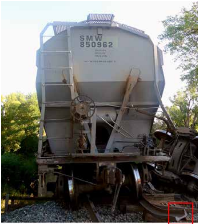
Figure 3. Vue vers le sud depuis la voie d'accès nord du pont avec mise en évidence de la soudure aluminothermique rompue
