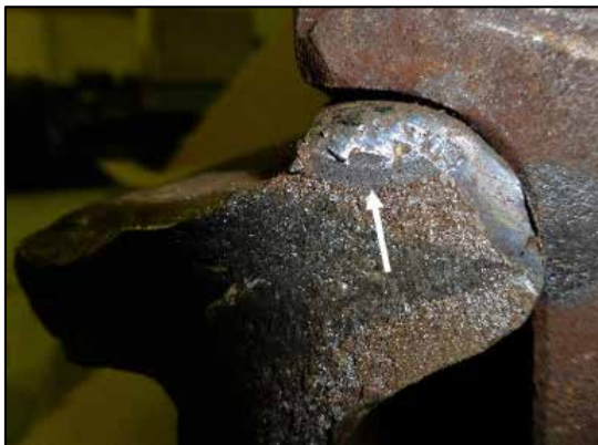
Figure 4. Côté intérieur de l'éclisse; la flèche indique les marques de fatigue
