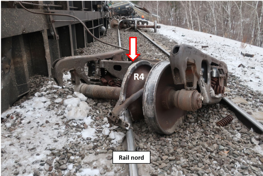
Figure 4. La roue R4 du wagon ATW 400515 (indiquée par la flèche) a été déplacée de la portée de calage et a glissé vers l'intérieur à côté de la roue L4 avant de s'immobiliser sur le rail nord (Source : BST)
