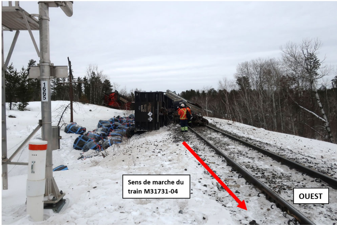
Figure 2. Ballots de sulfure de nickel tombés du premier wagon déraillé (Source : BST)
