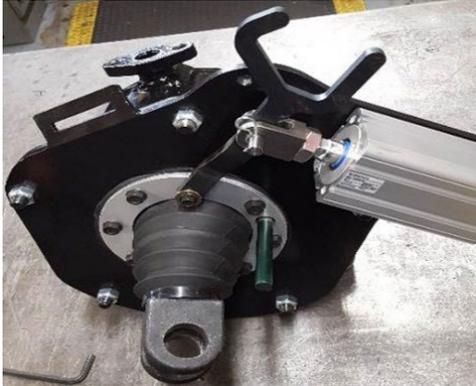
Figure 43. Frein de stationnement automatique APB de Wabtec intégré à un frein monté sur caisse (Source : Wabtec)
