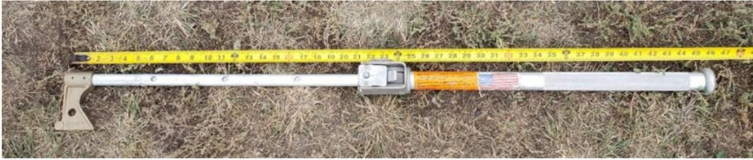
Figure E2. Le conducteur utilise une tige de frein pour serrer un frein à main du sol (Source : Aldon Company, Inc.)
