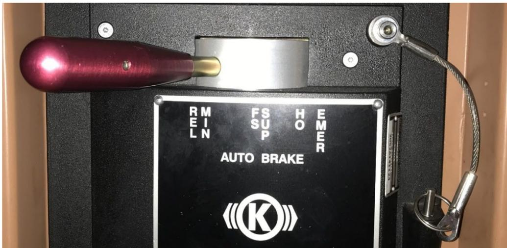
Pour desserrer les freins, le ML déplace la poignée du robinet de mécanicien à la position de desserrage. Cette action permet de diriger l'air du réservoir principal vers la conduite générale, ce qui permet d'y rétablir la pression de 90 lb/po<sup>2</sup>. Détectant cette augmentation de la pression de l'air dans la conduite générale, le distributeur de chaque wagon laisse s'échapper de l'air du cylindre de frein par la valve de retenue, ce qui éloigne les semelles de frein des roues.
