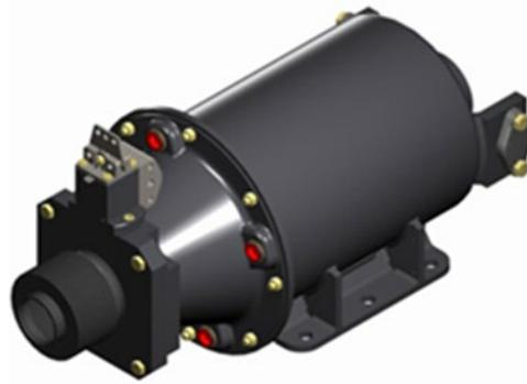
Wabtec fabrique aussi un module de commande pneumatique pour l'APB (figure 44). La commande pneumatique est un collecteur raccordé à l'APB, à la conduite générale et au réservoir auxiliaire de chaque wagon aux fins de contrôle manuel du frein à air automatique.
