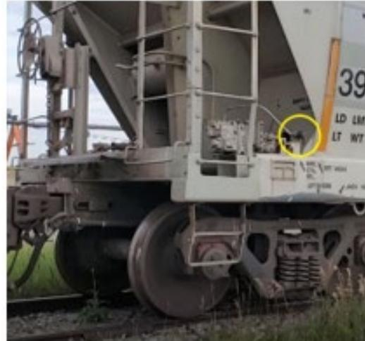
Les robinets servent à conserver la pression d'air<sup>41</sup> dans les cylindres de frein du wagon, au besoin, lorsque les freins du train sont desserrés et pendant que les réservoirs d'air comprimé des wagons sont rechargés.
