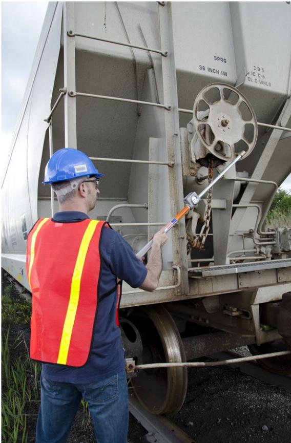
Dans le cadre de l'évaluation de la portée limitée, on n'a pas inclus une évaluation officielle de l'efficacité d'une tige de frein pour serrer les freins à main, mais selon des observations anecdotiques, un tel dispositif pourrait augmenter considérablement l'efficacité (c.-à-d. réduire le temps et l'effort) de la tâche avec un doublement potentiel du couple exercé.
