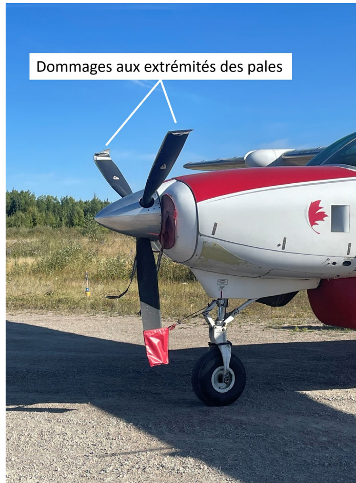
Figure 4. Dommages aux extrémités des pales de l'hélice (Source : Superior Airways Limited, avec annotations du BST)
