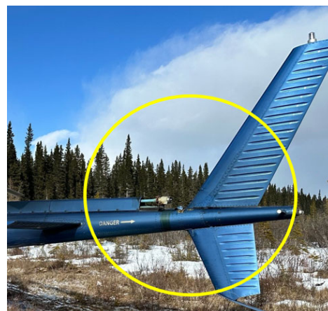
Figure 4. Marques sur la poutre de queue (mot « DANGER » et flèche) de l'hélicoptère à l'étude, et rayon approximatif de l'arc du rotor de queue (Source : Heli Explore Inc., avec annotations du BST)
