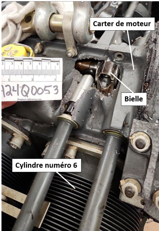
Figure 2. Carter de moteur à la base du cylindre numéro 6, avec la brèche créée par la bielle (Source : BST)
