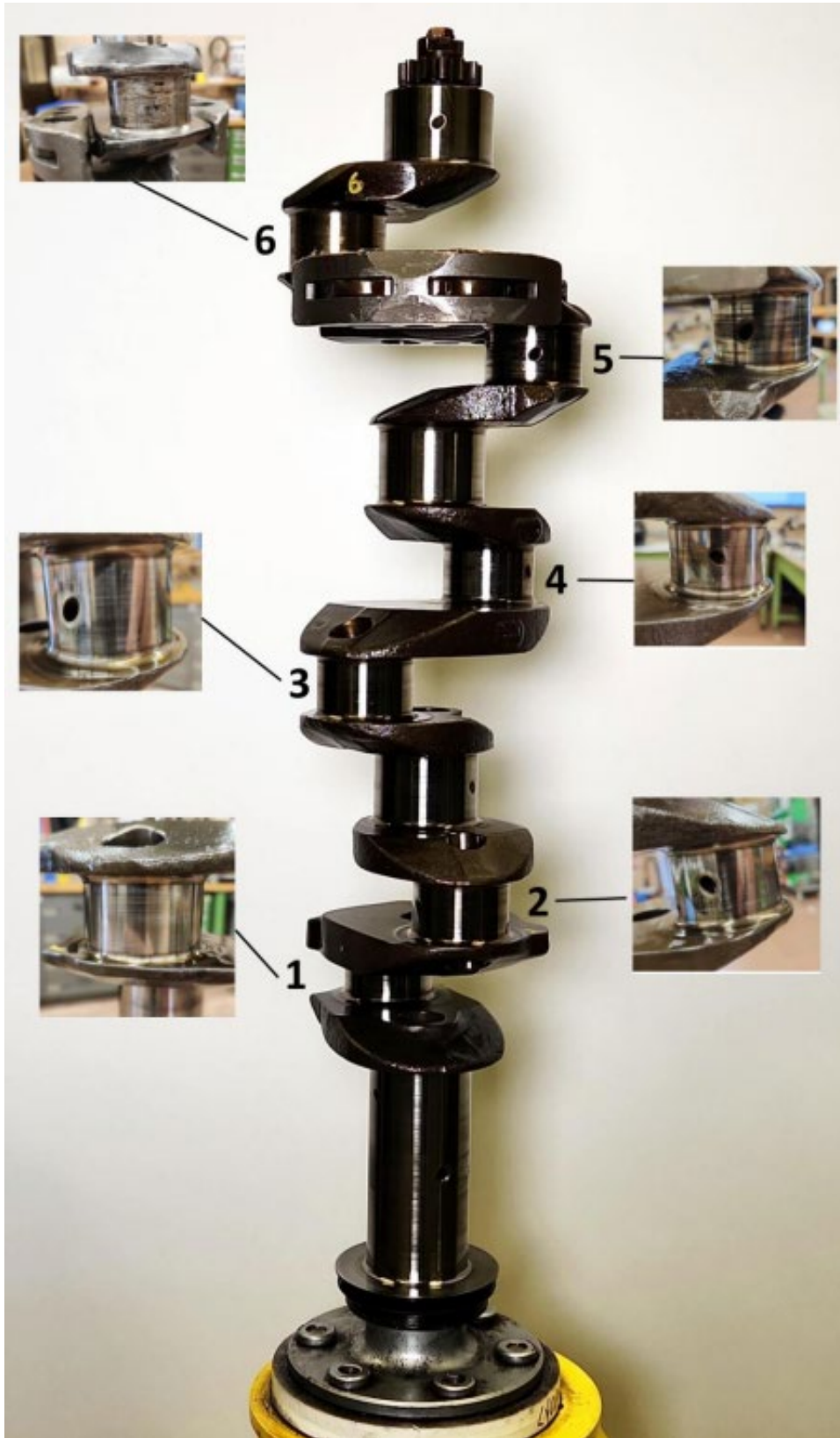
Figure 3. Rayures sur les manetons du vilebrequin (Source : BST)
