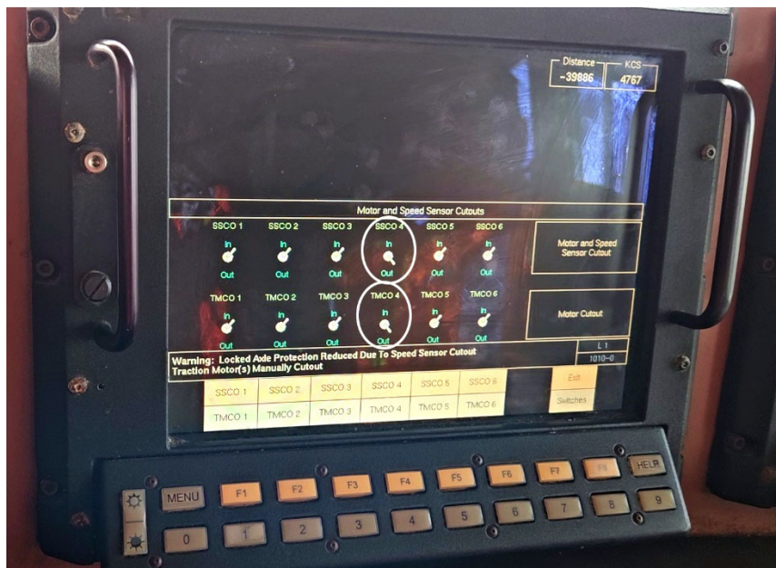
Figure 7. Moniteur de contrôle et clavier sur les locomotives de la série ES44AC; le moniteur affiche l'écran « Motor and Speed Sensor Cutouts » [Isolement des moteurs et des capteurs de vitesse], avec un cercle entourant les interrupteurs à bascule SSCO 4 et TMCO 4 (Source : BST)
