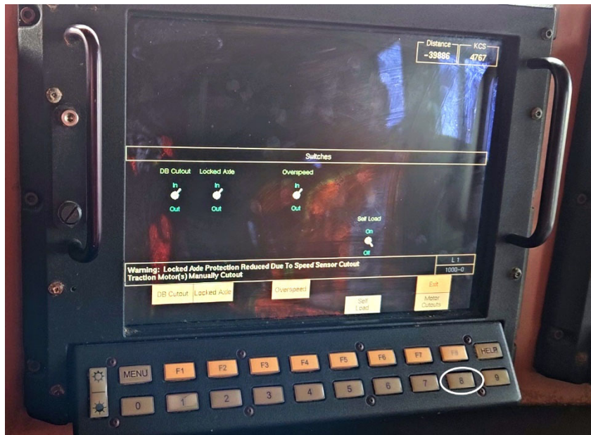
Figure 6. Moniteur de contrôle et clavier sur les locomotives de la série ES44AC; le moniteur affiche l'écran « Switches » [Interrupteurs] et un cercle indique l'emplacement de la touche physique 8 (Source : BST)
