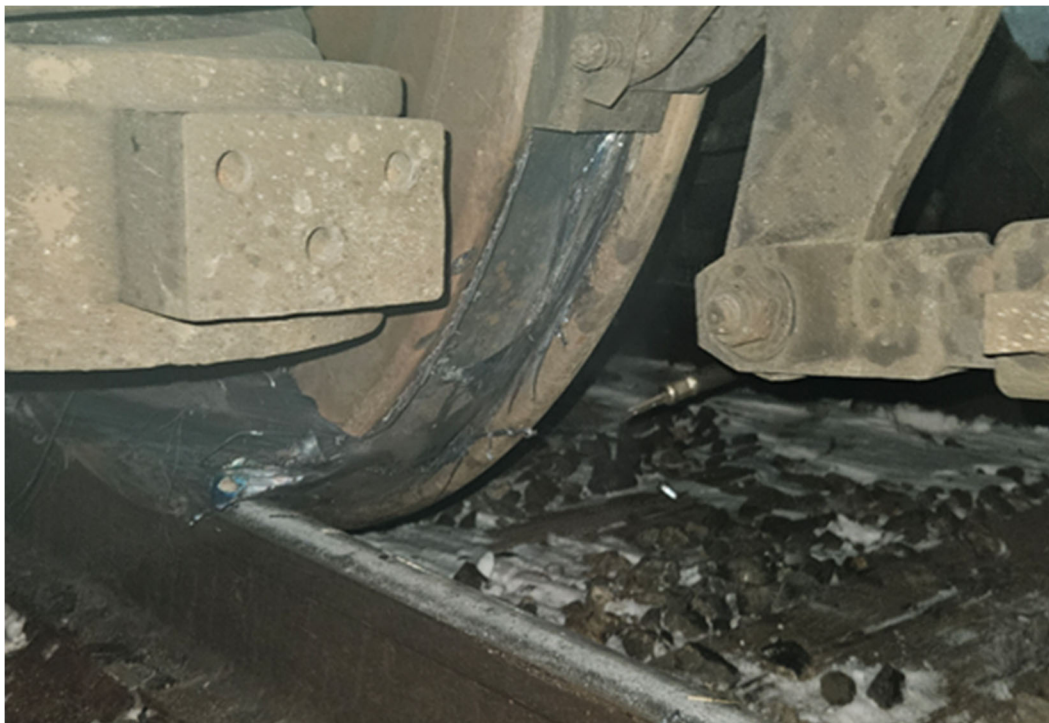
Figure 3. Dommages subis par la roue L4 de la locomotive KCS 4767 (Source : BST)
