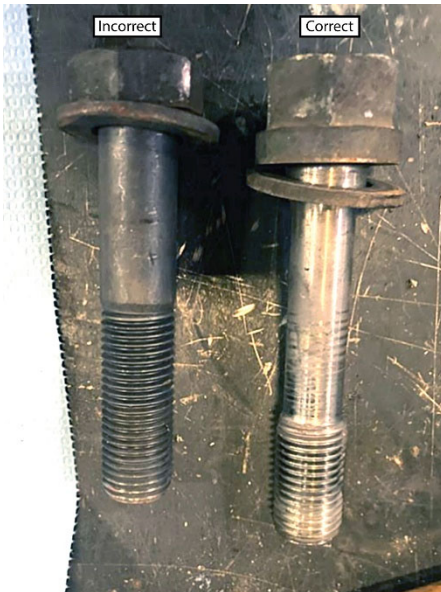
Figure 5. Mauvais boulon de fixation installé sur le moteur de traction n° 4 de la locomotive KCS 4767 et bon boulon de fixation à titre de comparaison (Source : CPKC)
