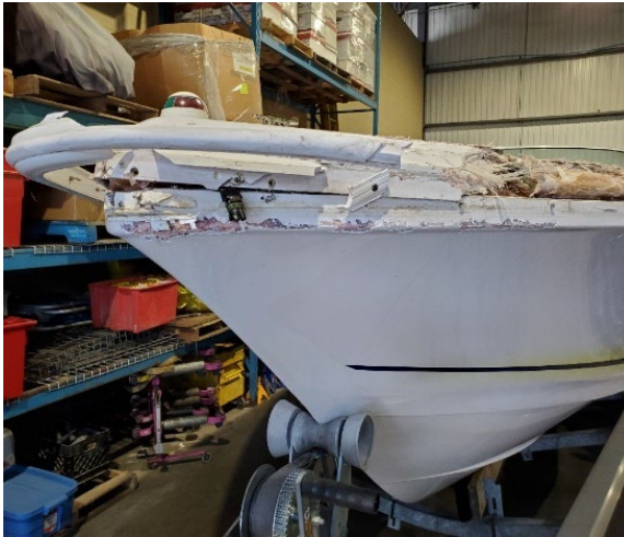
Figure 8. Avaries à la proue et au côté bâbord de l'embarcation de plaisance (Source : BST)
