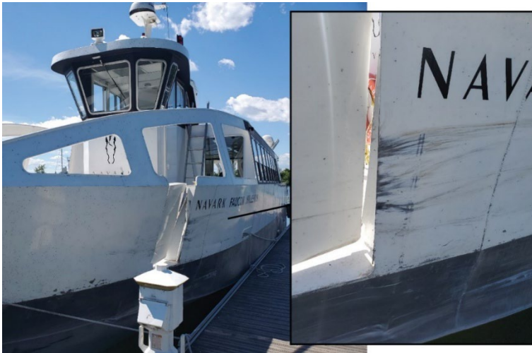
Figure 7. Avaries près de la barrière d'accès avant du Navark Faucon Millenium (Source : BST)
