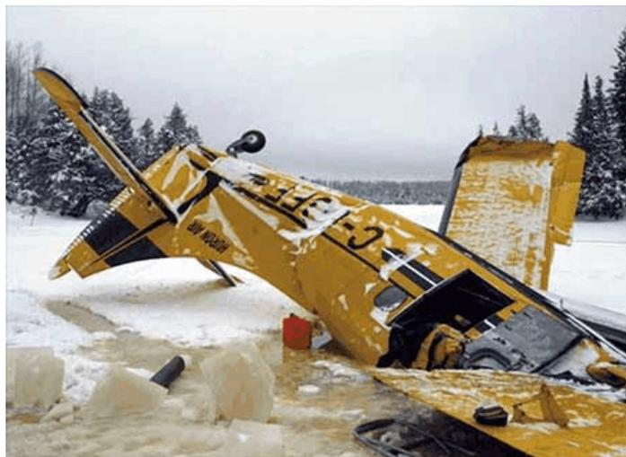
que le moteur produisait une grande puissance au moment de l'impact. L'examen des commandes de vol n'a révélé aucune anomalie. Le train d'atterrissage principal était équipé de roues et de skis. L'examen de l'épave a révélé que les deux skis étaient abaissés pendant le décollage. Les traces laissées dans la neige sur la bande d'atterrissage indiquent également que les skis étaient en position basse. L'examen des roues et des skis n'a pas révélé la présence de contamination sur la base des skis.
