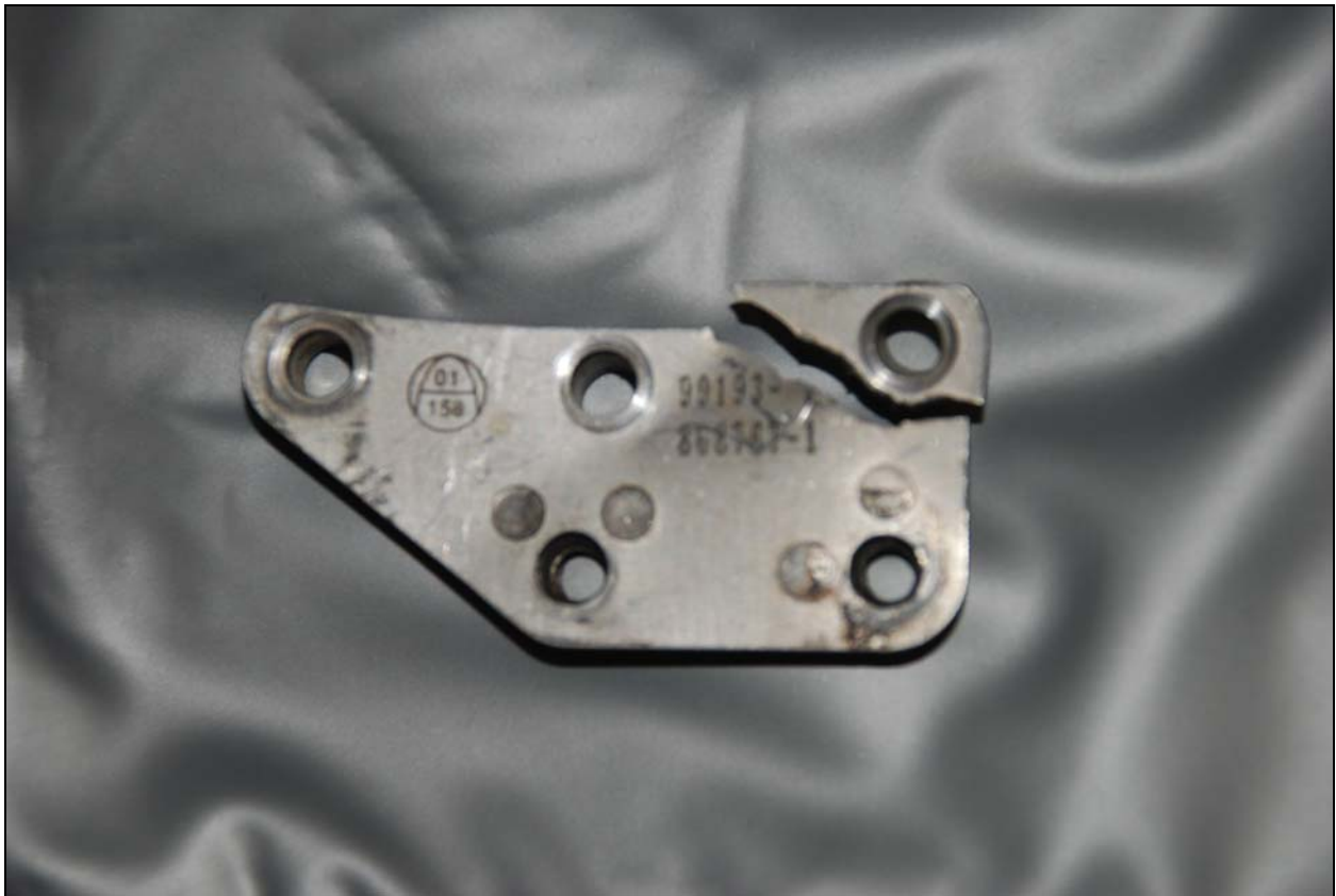
Photo 1. Partie supérieure du support du bloc régulateur de carburant du moteur de gauche
