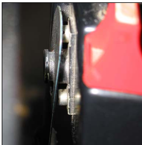
Photo 4. Plaque de verrouillage du levier de pas collectif incorrectement engagée sur l'épaule du bouton, et non dans la gorge (hélicoptère accidenté)
