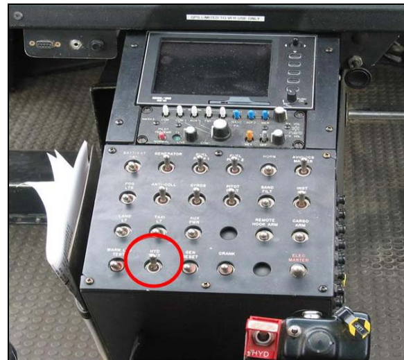
Photo 2. Commutateur d'essai des accumulateurs hydrauliques
