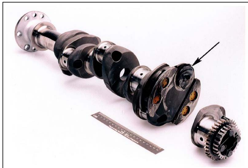
Photo 1. Rupture du vilebrequin du moteur LTSIO-360
