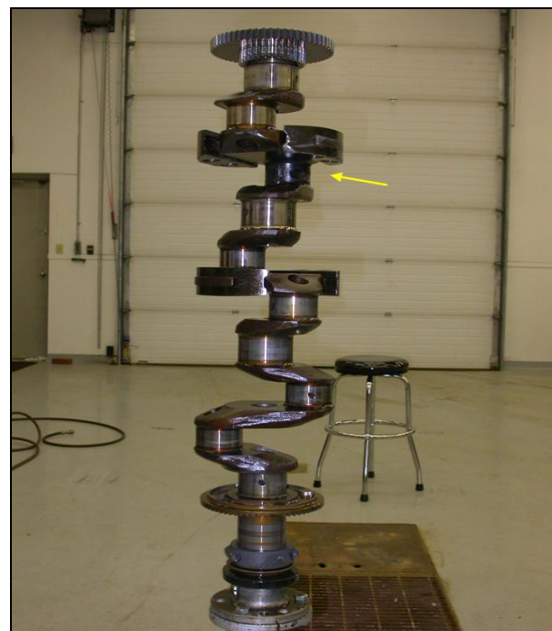
Photo 3. Partie surchauffée du vilebrequin.
