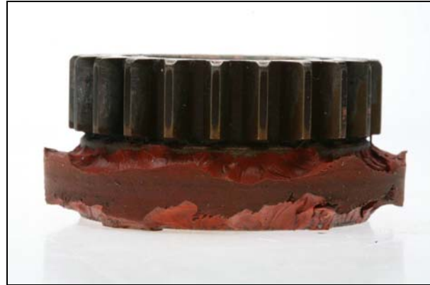
Photo 1. Dommages causés au caoutchouc de l'anneau.
