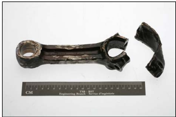
Photo 2. Dommages à la bielle numéro deux causés par la chaleur et par contact.
