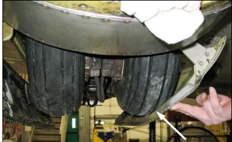
Photo 2. Zone où le pneu donne contre le train d'atterrissage.
