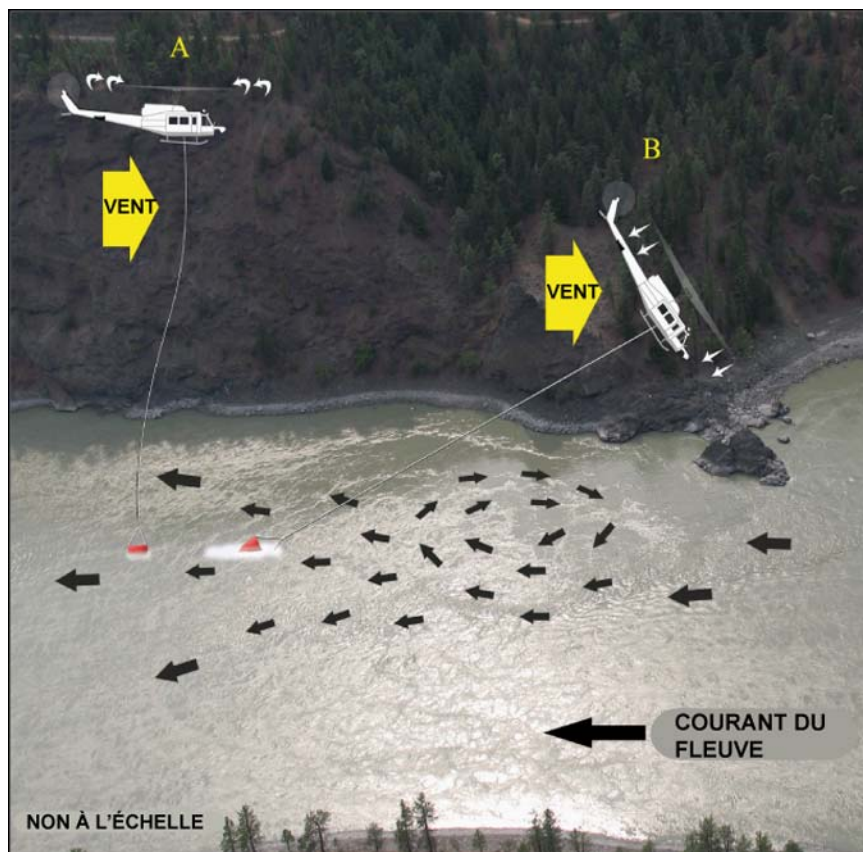
Figure 2. Déroulement de l'accident (anneaux tourbillonnaires puis ancrage du réservoir d'eau)
