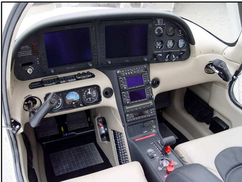
Photo 1. Commandes du poste de pilotage et de vol d'un SR22
