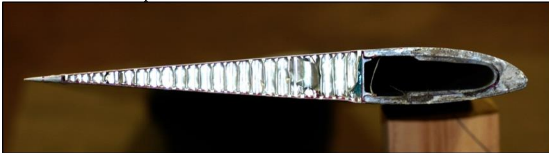
Photo 2. Coupe transversale de la pale fracturée (section 121)
