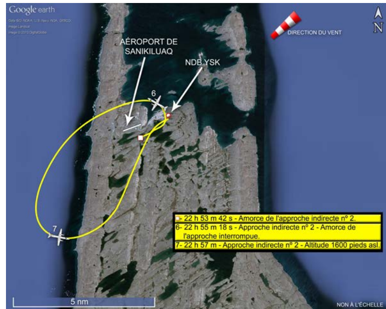
Figure 4. Trajectoire approximative de la deuxième approche indirecte (Source : Google Earth, avec annotations du BST)
