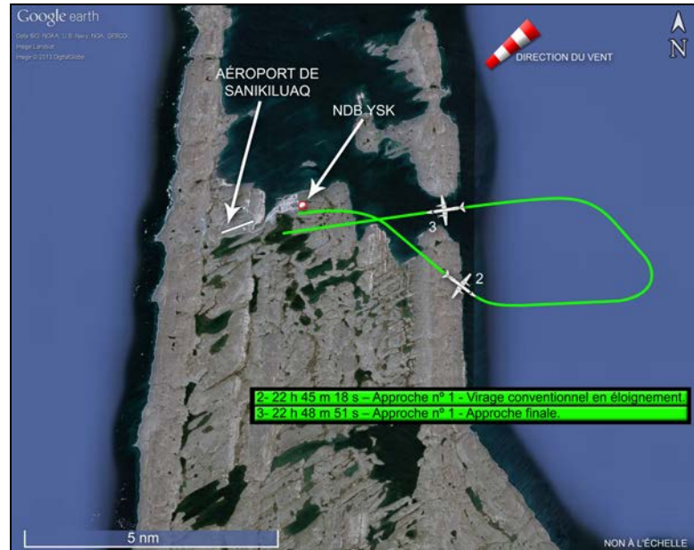
Figure 2. Trajectoire approximative de la première approche (Source : Google Earth, avec annotations du BST)
