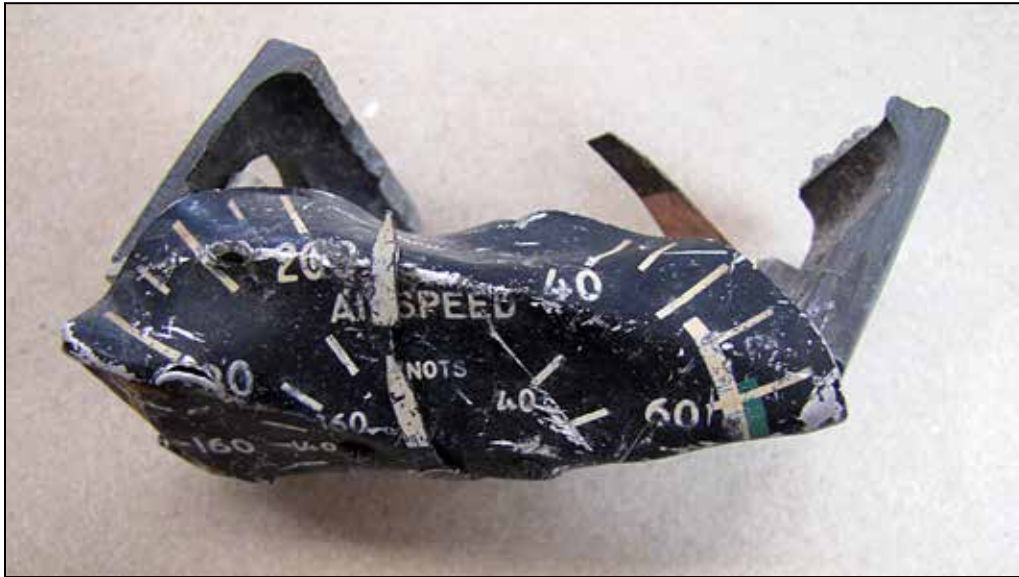
Photo 1. Position de l'aiguille coincée de l'anémomètre de l'aéronef en cause
