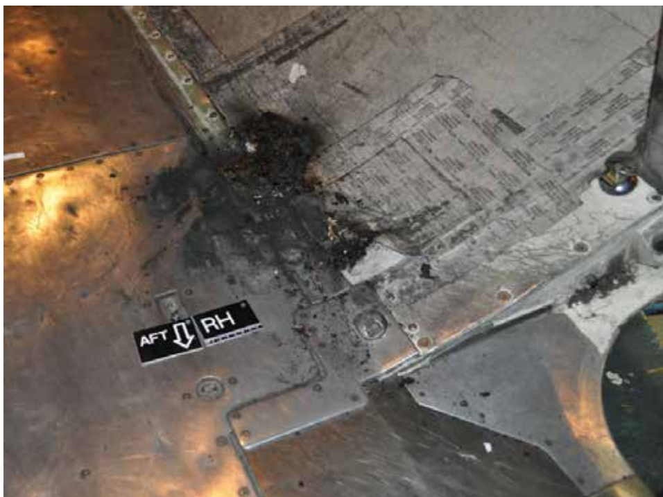
Figure 2. Dommages causés par les flammes dans la soute inférieure arrière
