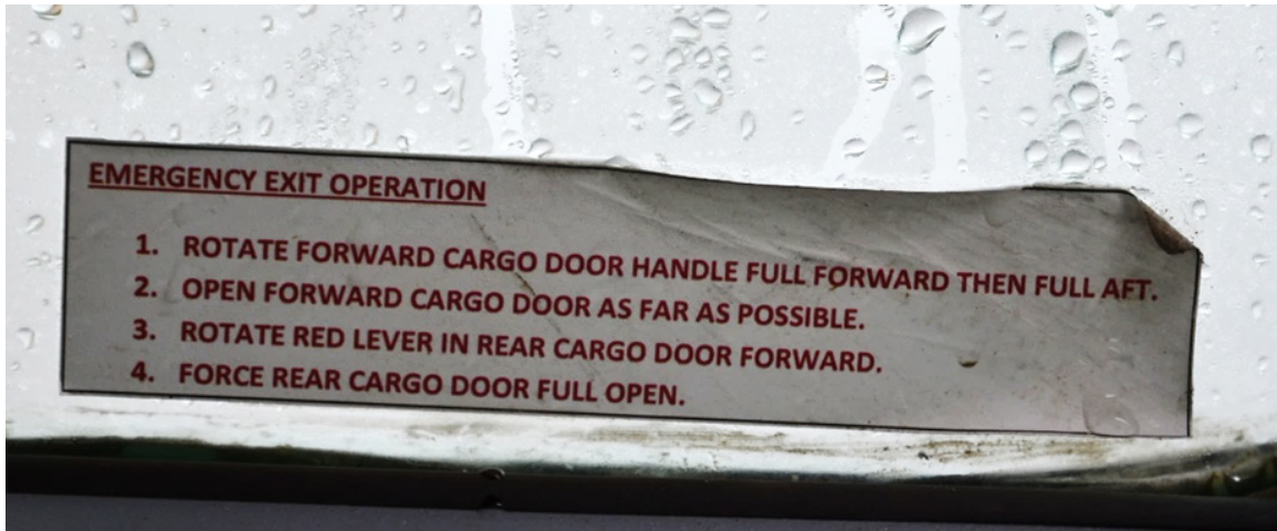
Figure 7. Instructions d'utilisation de la porte de soute à deux battants comme issue de secours à bord de l'avion à l'étude (Source : BST)
