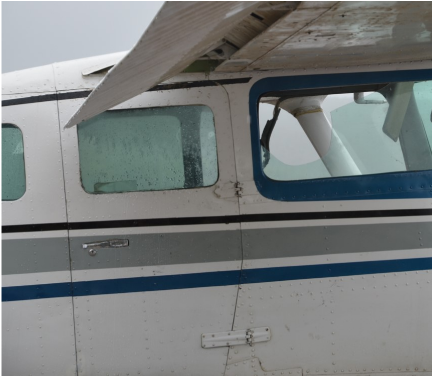
Figure 6. Image montrant la position des volets sortis à 20° et bloquant le battant avant de la porte de soute (Source : BST)
