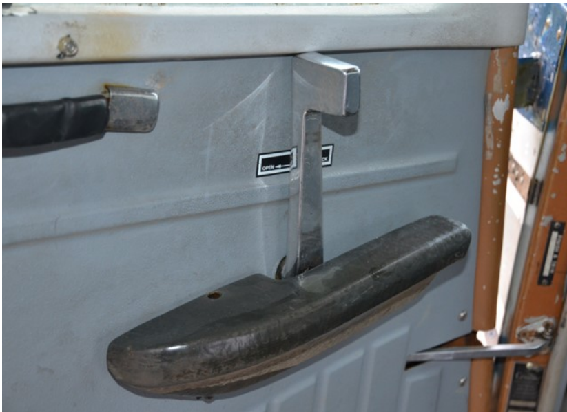
Figure 3. Poignée de la porte du pilote en position fermée (Source : BST)
