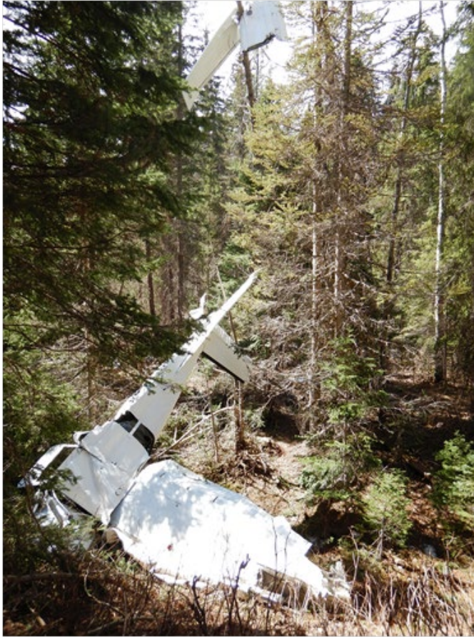
Figure 3. L'aéronef à l'étude sur les lieux de l'accident, l'aile droite au sommet d'un arbre (Source : BST)
