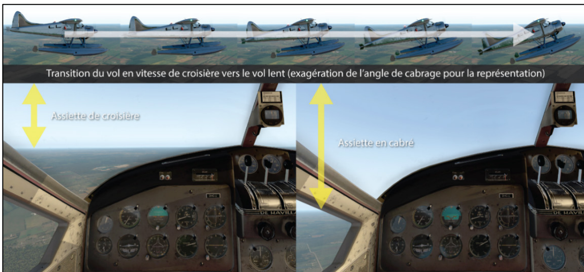
Figure 3. Références visuelles de l'assiette depuis le poste de pilotage (Source : BST)
