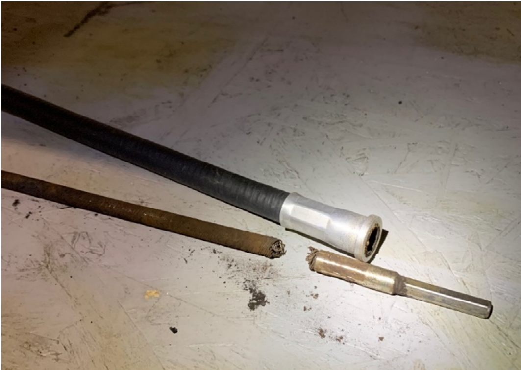
Figure 2. L'arbre d'entraînement flexible de volet défectueux de l'aéronef à l'étude (Source : Chemin de fer Canadien Pacifique)
