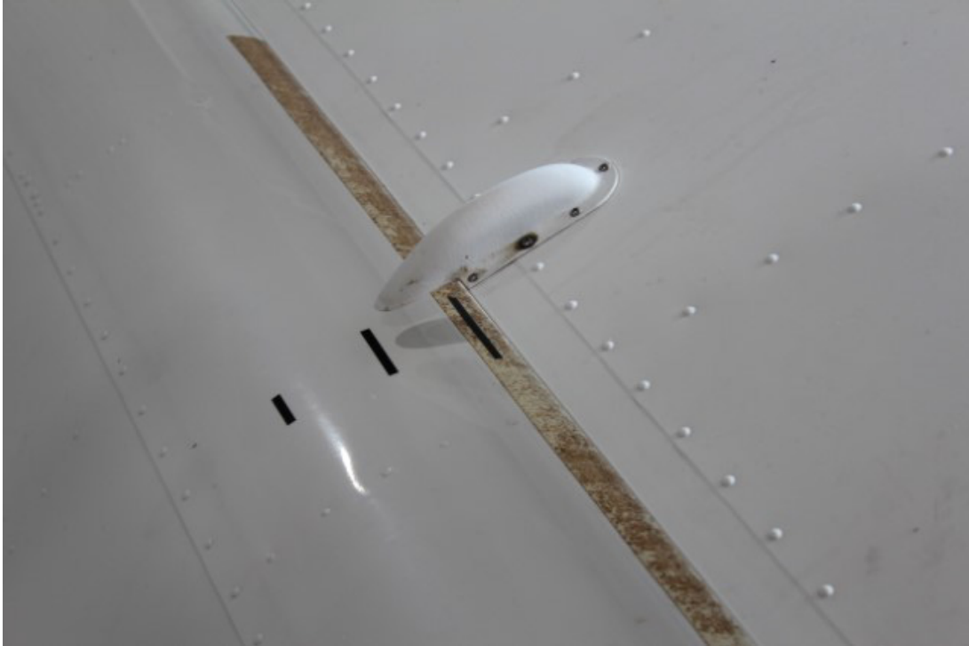
Figure 6. Les marques des indicateurs de position des volets à un angle de braquage de 10°, de 20° et de 30° sur l'aile gauche d'un aéronef de référence. La position du volet présentée indique un angle de braquage de 30°. (Source : BST)
