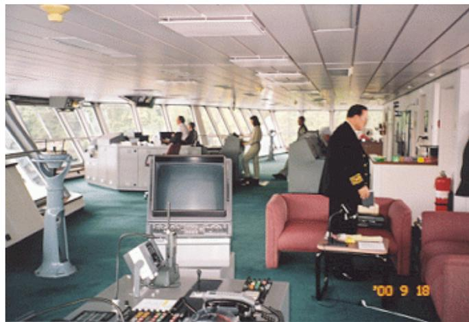
À bâbord et à tribord de la console, on retrouve des répéteurs de gyrocompas sur pied qui sont munis d'un taximètre. Le navire est gouverné par un timonier depuis un poste de barre placé sur l'axe longitudinal du navire, derrière la console. Des commandes de barre et de propulsion sont aussi placées sur les consoles de chaque aileron de passerelle fermé. Celles-ci servent surtout à l'accostage et à l'appareillage. L'erreur du gyrocompas était nulle.
