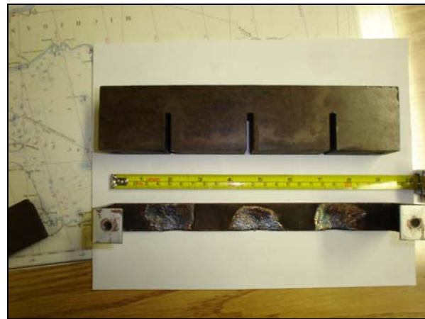
Photo 13. Vue du support en acier montrant le résultat d'un arc électrique et le bloc isolant en bakélite.
