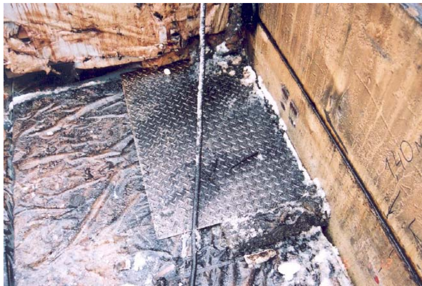
Photo 2. Vue de l'hiloire de cale et de la plaque d'aluminium placée sur un fardeau de bois à proximité du lieu du soudage
