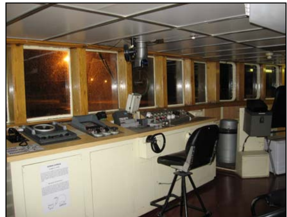
Photo 2. Vue du pupitre central montrant le radar tribord. La photo ne montre pas les autres radars et le SCE à bâbord (gauche).
