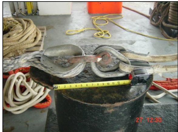
Photo 3. Fixation du câble de remorque à la patte d'oie
