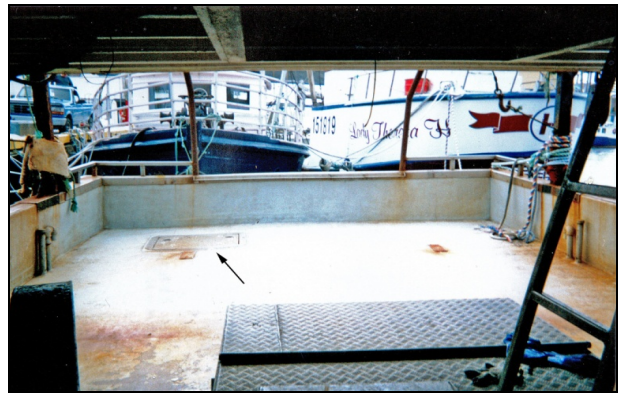
Photo 2. Écoutille d'accès à la cambuse.
