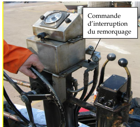
Photo 3. Commande d'interruption du remorquage (poste sur le toit de la timonerie).
