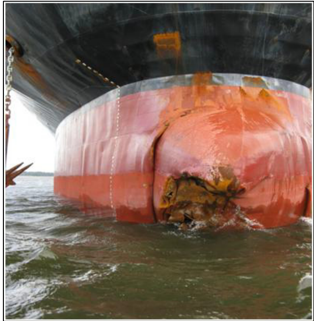
Photo 5. Dommages causés à l'étrave à bulbe.
