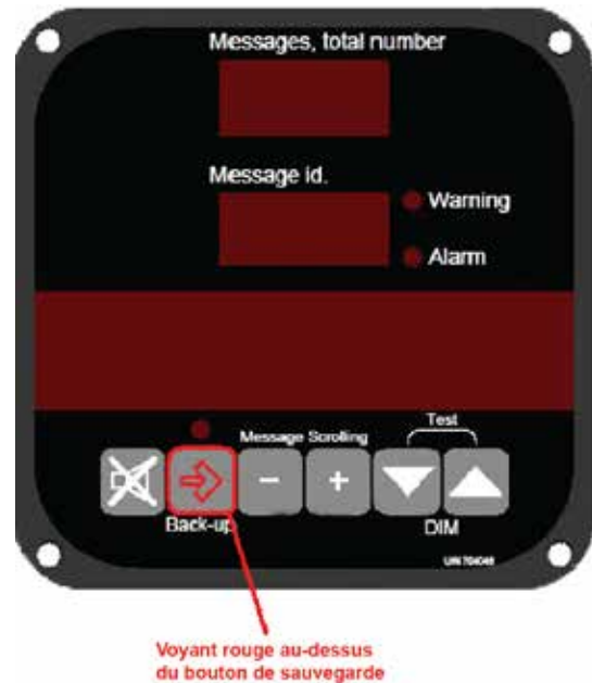
Figure 4. Panneau d'alarme pour activer la sauvegarde des données.
